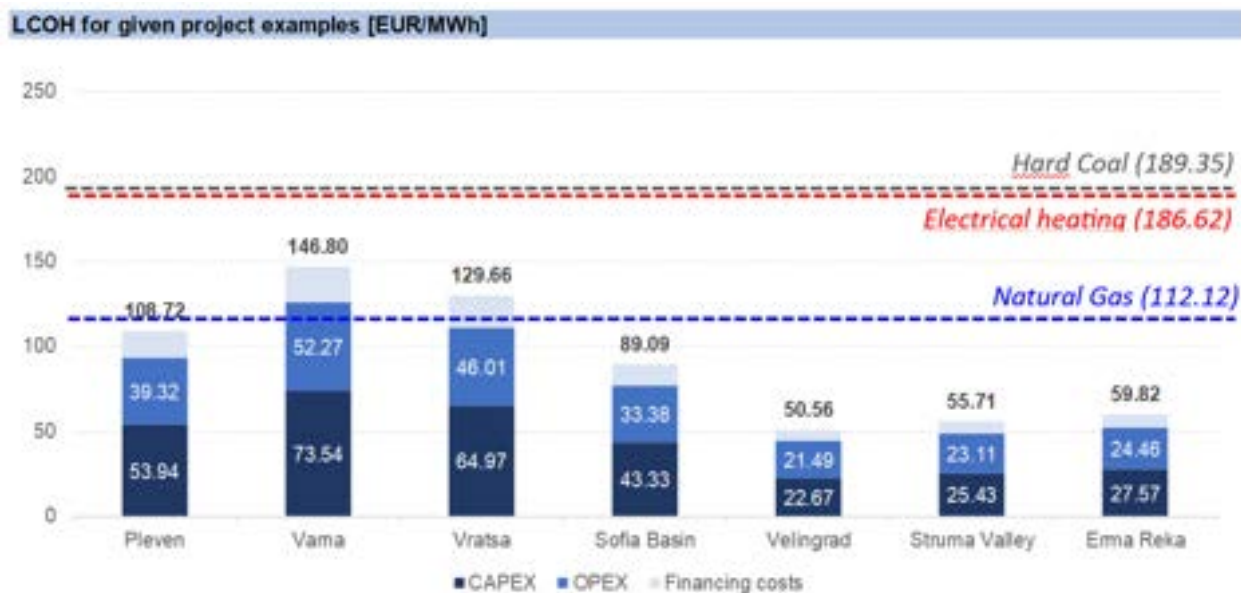
Графика 63: LCOH (Евро/ MWh) за проектни казуси в избраните геотермални райони в сравнение с икономически LCOH на алтернативни технологии, като се вземат предвид 3600 експлоатационни часа годишно
